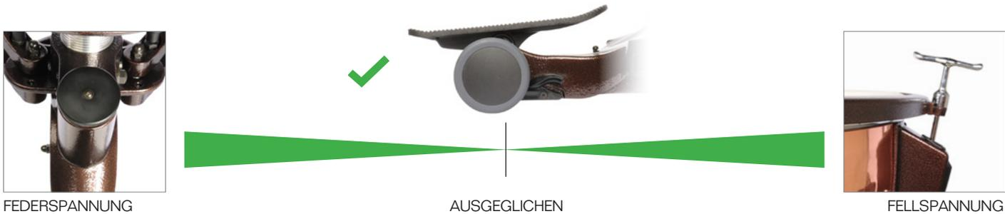
Das Balanced Action Pedalsystem funktioniert ordnungsgemäß, wenn die Fellspannung und die Federspannung ausgeglichen sind. Wenn der Grundton nicht die richtige Fellspannung hat, oder wenn die Federspannung zu schwach oder zu stark ist, bleibt das Pedal nicht stehen und der Ton verändert sich.
