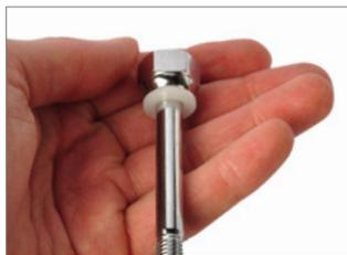
Tragen Sie etwas Lithiumfett an der Spitze der Spannschraube auf.
